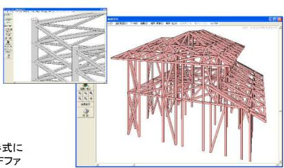
扱える外力は、節点荷重・部材荷重・強制変位・ 温度荷重・自重で、これらを組み合わせることも 可能です。また、引張材・圧縮材の設定や、基 礎の浮き上がりを考慮した解析も可能で、境界 (拘束)条件など様々な設計者の意図を反映させ ることができます。
