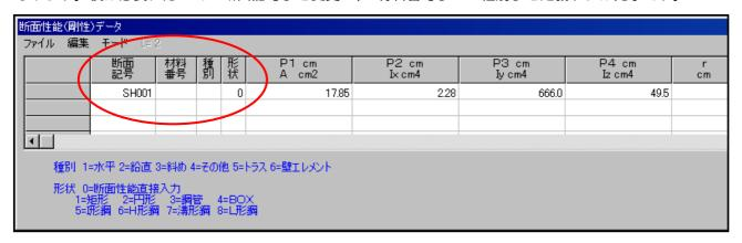
断面の定義方法には二つの手段があります。「形状」データに  $1 \sim 8$  を入力すれば、寸法による定義ができます。この場合の入力データは  $P1 \sim P4$  を寸法値として入力します。「形状」データに 0 を入力すれば、性能値を直接入力して断面を定義します。この場合の入力データは 断面積 (A) 各剛性 (Ix, Iy, Iz) を入力します。
